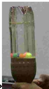
石が下に落ちない方法とは?! 水と砂が入っているペットボトルに指でたたくと・・・！マジックみたいな液状化の実験です
