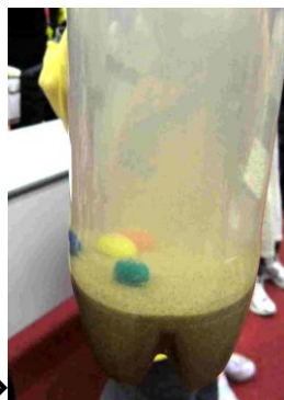
石が下に落ちない方法とは?! 水と砂が入っているペットボトルに指でたたくと・・・！マジックみたいな液状化の実験です
