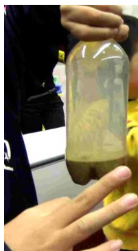
石が下に落ちない方法とは?! 水と砂が入っているペットボトルに指でたたくと・・・！マジックみたいな液状化の実験です
